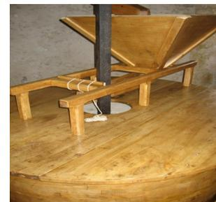
Une 2<sup>e</sup> **trémie** achemine le grain vers les **meules** qui sont recouvertes par un ensemble de pièces de bois.
