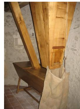
Après avoir transité par un système de **bluterie** pour séparer la farine des impuretés (1<sup>er</sup> étage), celle-ci arrive dans l'**ensachoir** pour être prête à la livraison.
